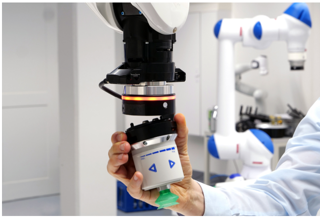
Módulo de cambio rápido RMQC durante el cambio manual de garras
